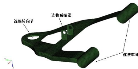
图 1 控制臂结构示意图
